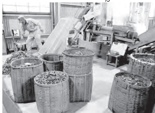
雨畑茶工場の中。 集めた茶葉を蒸し器に投入する直前の様子。
