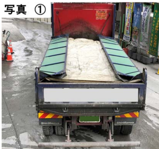
荷台への防じんシート等の設置
