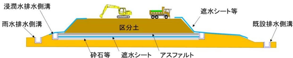
図 2-5(4) 主な施工手順（区分土搬出）
