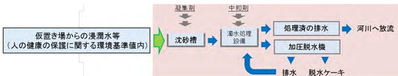
図 3-4 早川東工事施工ヤードにおける排水フロー
