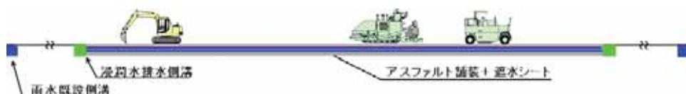
図 2-8(1) 塩島地区（南）発生土仮置き場における主な施工手順（アスファルト舗装施工）
