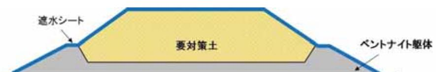
図 2-5(3) 塩島地区（南）発生土仮置き場における主な施工手順（仮置き）
