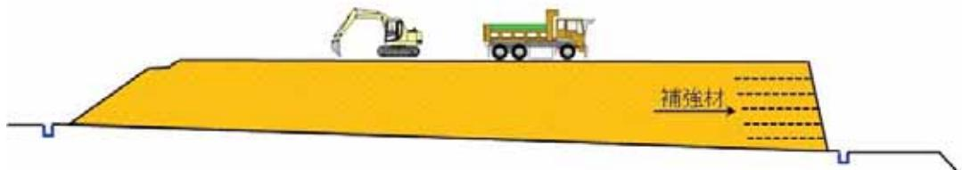
図2-4(3) 塩島地区（河川側）発生土仮置き場における主な施工手順（発生土搬出）
