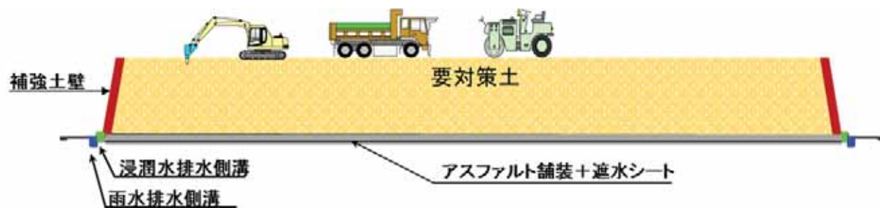
図 2-5(2) 塩島地区（下流）発生土仮置き場における主な施工手順（要対策土搬入、締固め、転圧等）
