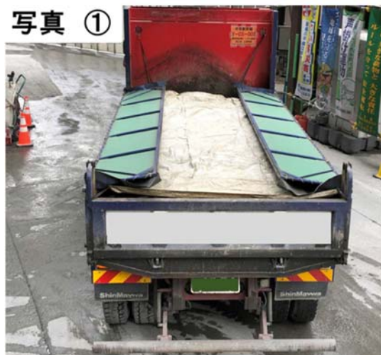
荷台への防じんシート等の設置
