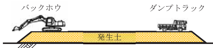
図 2-4 (3) 奈良田地区発生土仮置き場における主な施工手順（発生土搬出）
