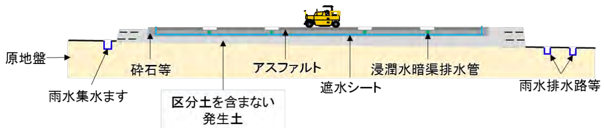
図 2-5(1) 主な施工手順 (アスファルト舗装施工)
