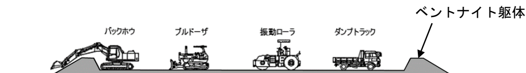
図 2-5(1) 雨畑地区発生土仮置き場における主な施工手順（ベントナイト躯体設置）
