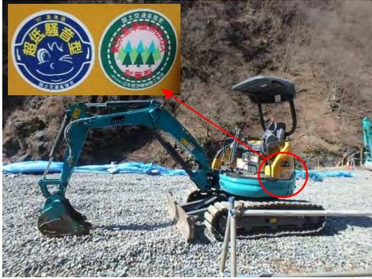
写真4-1-7-1 排出ガス対策型・低騒音型
