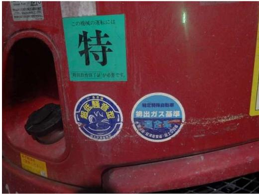
写真 4-1-8-1 排出ガス対策型・低騒音型
