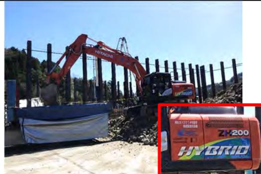
写真 4-1-6-18 低炭素型建設機械の採用
