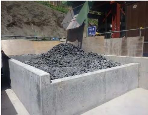
写真 4-1-8-20 建設汚泥の脱水処理
