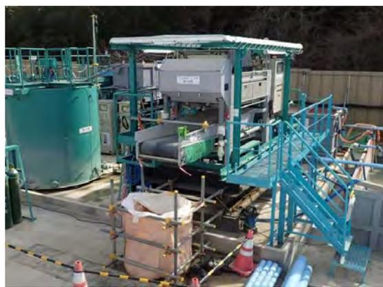
写真4-1-5-19 建設汚泥の脱水処理
