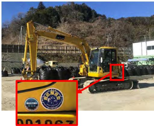
写真4-1-6-3 低騒音型建設機械の採用
