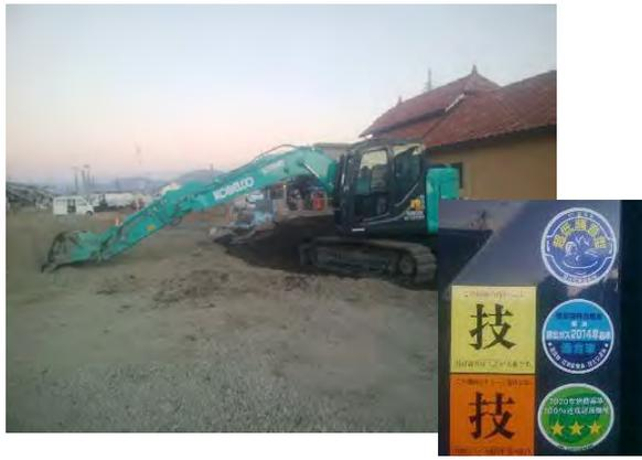
写真4-1-2-1 排出ガス対策型・低騒音型建設機械の採用
