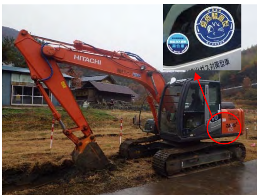
写真4-1-5-1 排出ガス対策型・低騒音型 建設機械の採用
