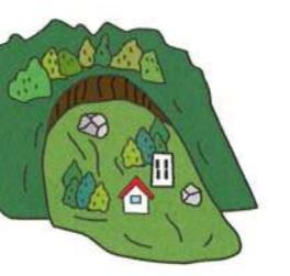
斜面の一部あるいは全部が地下水の影響と重力によってゆっくりと斜面下方に移動する現象をいいます。一般的に移動する土塊量が大きいため、甚大な被害を及ぼします。
