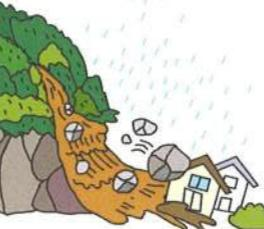
川底の石や土砂が長雨や集中豪雨などによって一気に下流へと押し流されるものをいいます。その流れの速さは規模によって異なりますが、時速20~40kmという速度で一瞬のうちに人家や畠などを壊滅させてしまいます。
